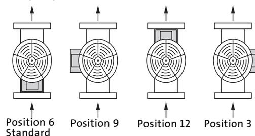
Fig. 4 Positions de la boîte à bornes
