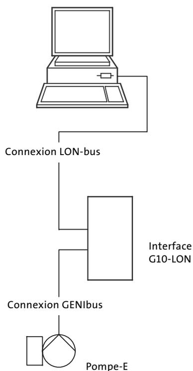
Fig. 6 Structure d'un poste central de télégestion
