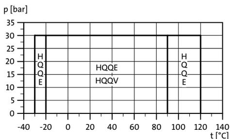
Fig. 14 Plage de fonctionnement des garnitures mécaniques standards
